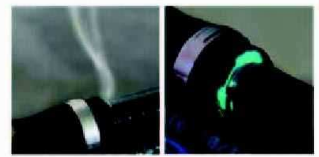
Дым указывает на утечку Ультрафиолетовый свет показывает место выхода краски с дымом
