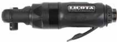
PAR-03028 Пневмотрещотка 3/8" 75 Нм (7.6 кГм), ударная, промышленная
